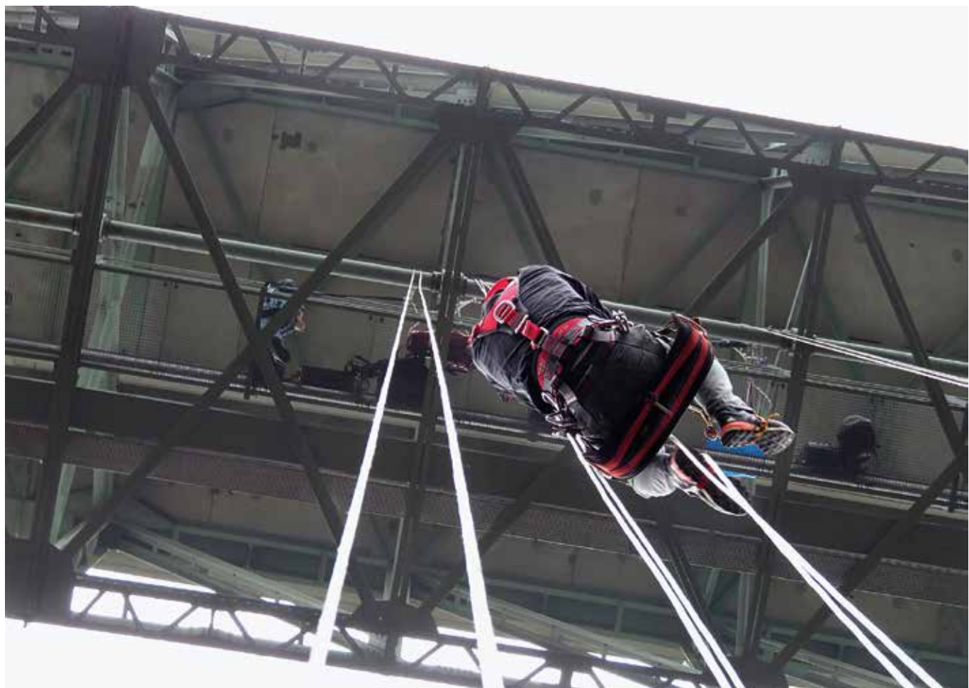
Using the Giant descender to ascend during the prototype testing phase. Ascenso después de unas pruebas de descenso con prototipos del descensor Giant. Pont de Fenil, Vaud, Switzerland (courtesy of Corde-Access SA, ph. Mauro Galimberti).
